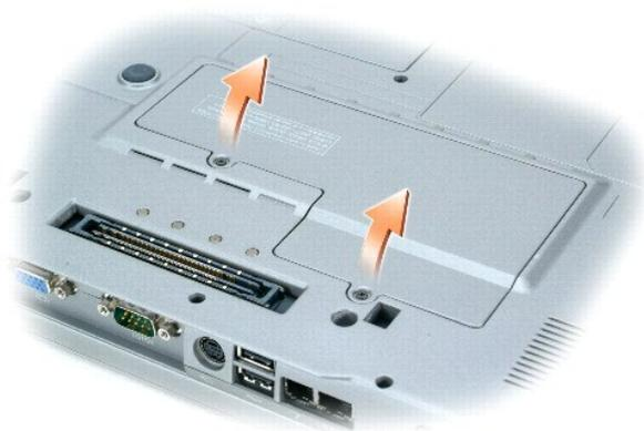
3. Se un modem non è già installato, passare al [punto 4](#). Se si sta sostituendo un modem, rimuovere quello precedentemente installato.
