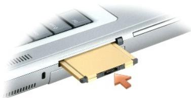
Il computer riconosce la maggior parte delle Schede PC e carica automaticamente il driver di periferica appropriato. Se il programma di configurazione richiede di caricare i driver del produttore, usare il disco floppy o il CD fornito con la scheda PC.
