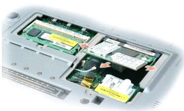
➔ **AVVISO:** I connettori sono calettati per garantire il corretto inserimento. Se si incontra resistenza, controllare i connettori e allineare correttamente la scheda.
