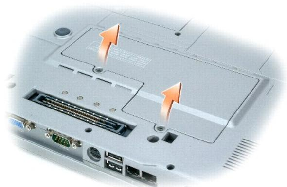
3. Se una scheda Mini PCI non è già installata, passare al [punto 4](#). Se si sta sostituendo una scheda Mini PCI, rimuovere quella precedentemente installata.
